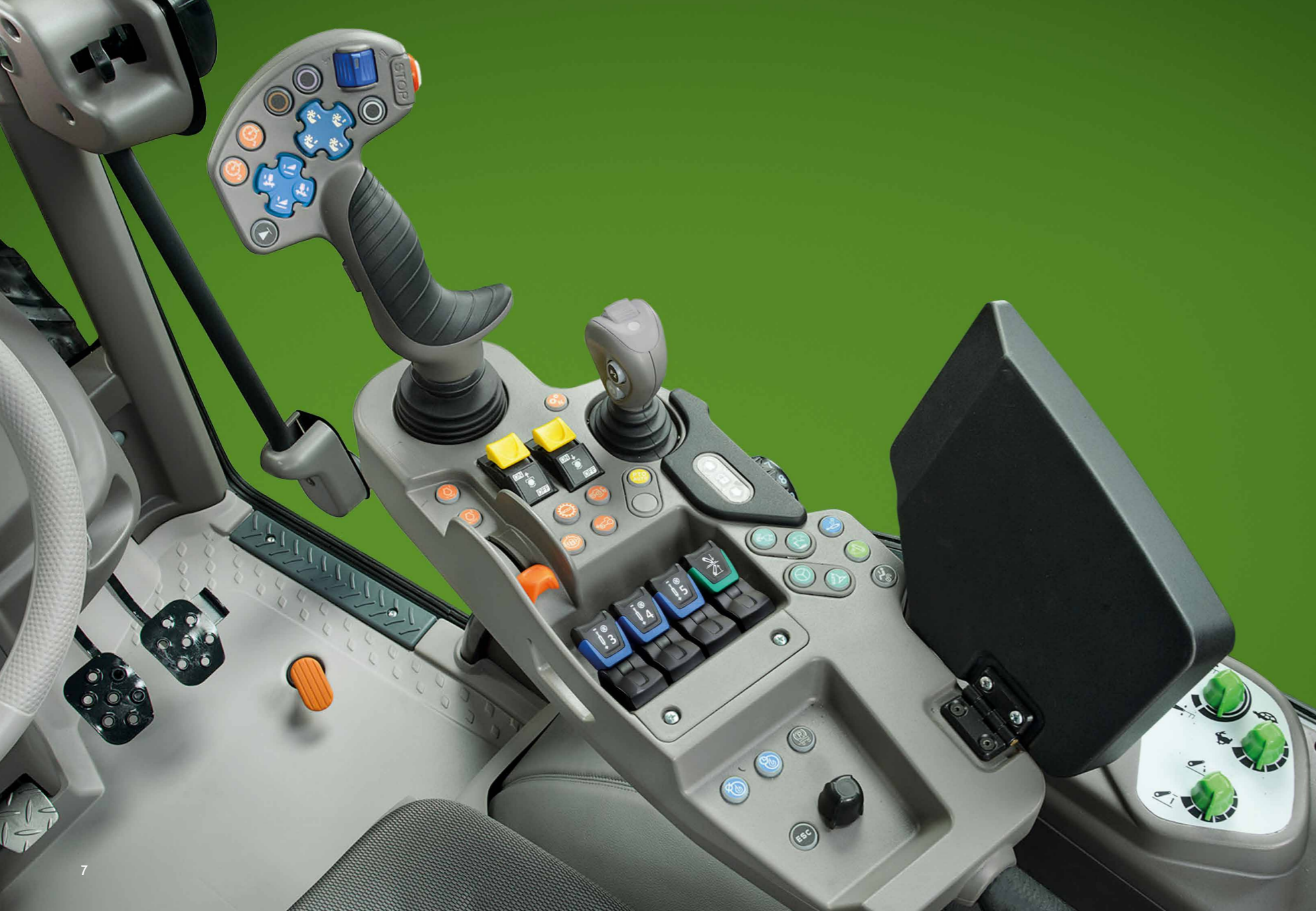
Farblich eindeutig differenzierte Drehpotentiometer und Drehschalter für eine intuitive Handhabung und Bedienung.
