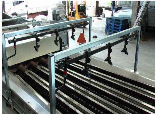
Wasser-Sprühsystem über Größensortierer
