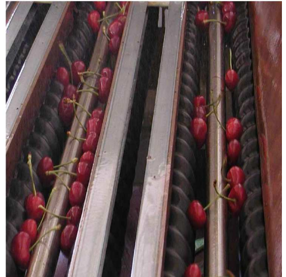
Die Spiralschrauben sorgen für eine gleichmäßige Ausrichtung der Frucht
