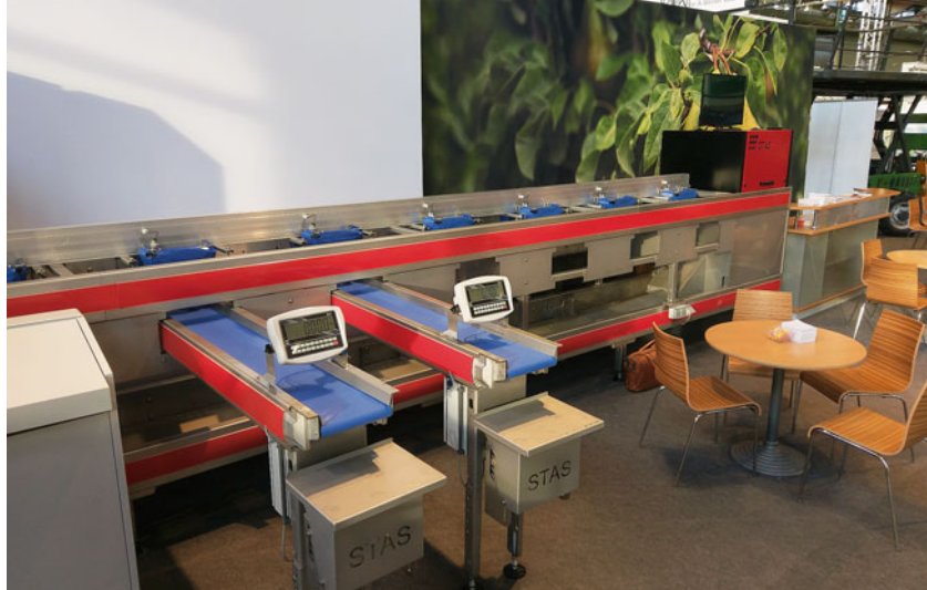
Die Sortiermaschine von Stas verfügt über eine optische Größensortierung, bei der vollautomatisch Größe und Farbe der einzelnen Früchte erfasst werden
